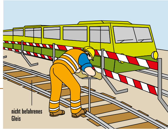
Feste Absperrung zwischen Betriebsgleis und gesperrtem Arbeitsgleis
