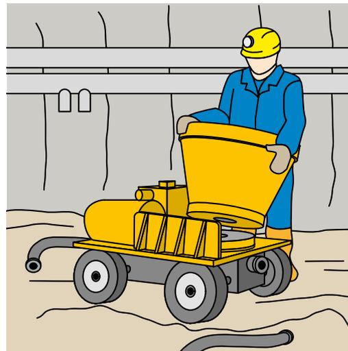
Reinigung der Spritzbetonmaschine
