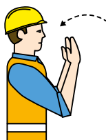
HERKOMMEN Einleiten einer Bewegung in Richtung des Einweisers
