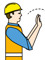
ENTFERNEN Einleiten einer Bewegung weg vom Einweiser
