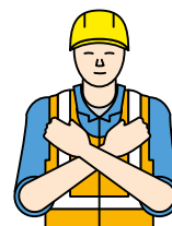
ENDE DER EINWEISUNG Unterarme in Brusthöhe kreuzen
